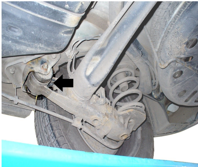
Bild 15. Lagerelemente von längs gerichteten Stützstangen
