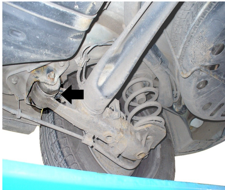
Рисунок 15. Опорные элементы продольных опорных стержней
