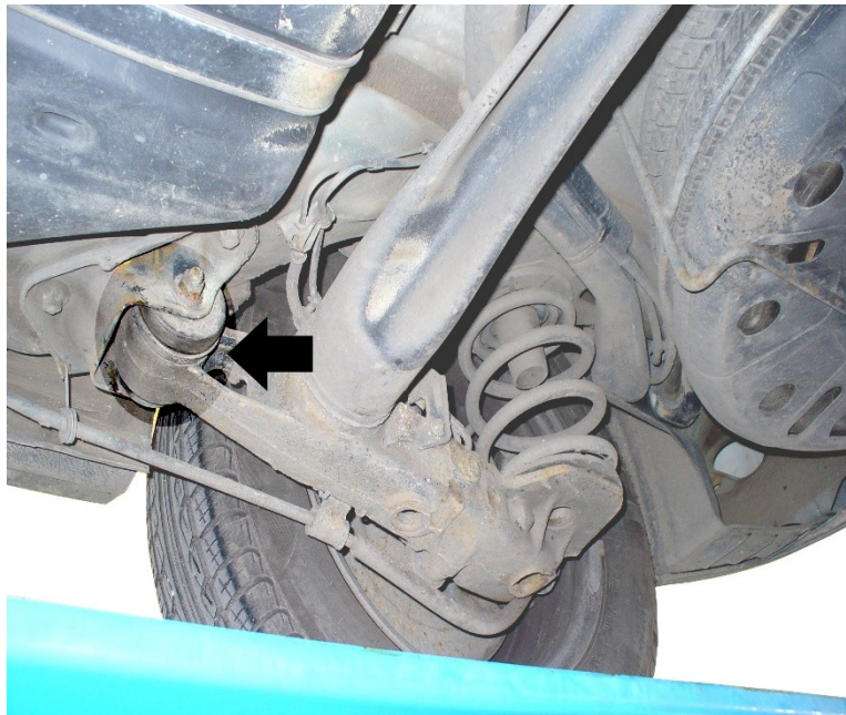
Figura 15. Elementos de apoyo de las varillas de soporte dirigidas longitudinalmente
